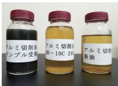
浄油サンプル(左:浄化前、中央:浄油、右:新油)
