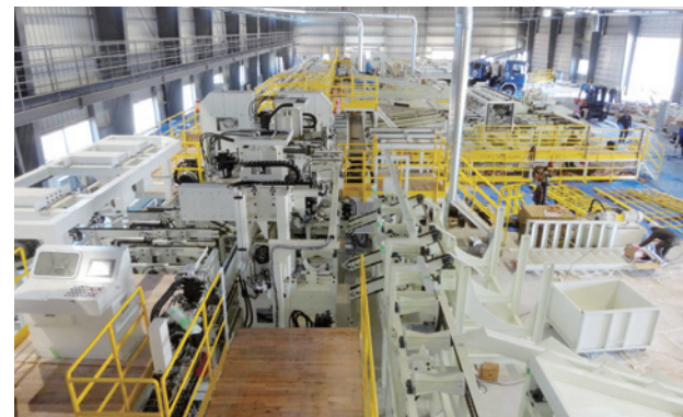
丸太から住宅の柱や板材へと加工する無人製材設備
