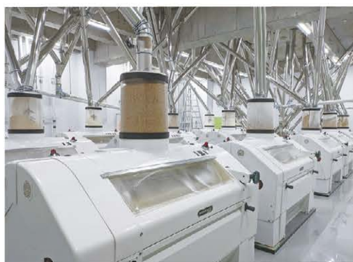
挽砕(胚乳部を砕き、細かく粉にする)工程
