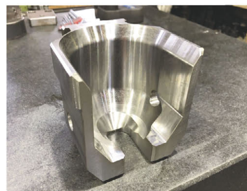
旋盤と5軸マシニングセンタで加工した治具
