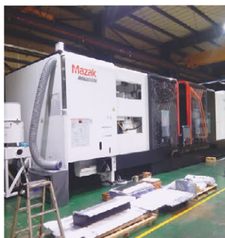
長尺・大径ワークの旋削からミル加工まで可能な横形複合加工機
