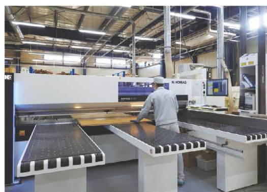
合板、MDF、パーティクルボードなどの板材を高速かつ正確にカットでき、WCC(CAD/CAMシステム)とのデータ連動にも対応する最新機器
